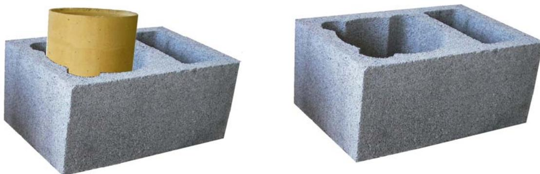
Il Camino **Edilsanto** con **camicia a presa d'aria** è realizzato in cls alleggerito vibrocompresso in argilla espansa e camino interno in refrattario alt.cm. 33 ad elevata resistenza termica, aventi spessore da 15 a 24 (a seconda del diametro) con giunto ad incastro maschio/femmina.
